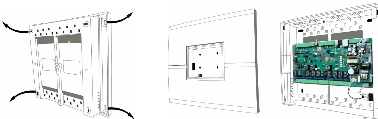
3. Закрепите Регулятор в месте его применения, используя винты крепления и монтажные отверстия корпуса:
