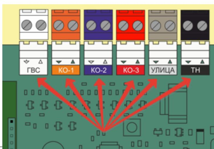
6. Если реализуемой конфигурацией системы отопления предусмотрено управление котлом (котлами) по цифровому интерфейсу, установите универсальную плату (платы) цифровой шины (в комплект поставки не входят, приобретаются отдельно), в соответствующие гнезда платы Регулятора.
