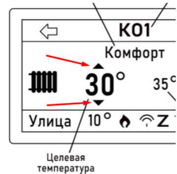
Каждая кривая ПЗА строится от температуры воздуха 20 градусов. Поэтому при необходимости увеличить или уменьшить расчетную температуру теплоносителя не меняя при этом выбранной кривой зависимости, пользователь может задавать некую виртуальную целевую температуру в контуре управляемом по ПЗА, изменяя ее в большую или меньшую сторону относительно эталонных 20-ти градусов. При этом изменение (сдвиг) кривой происходит автоматически.
