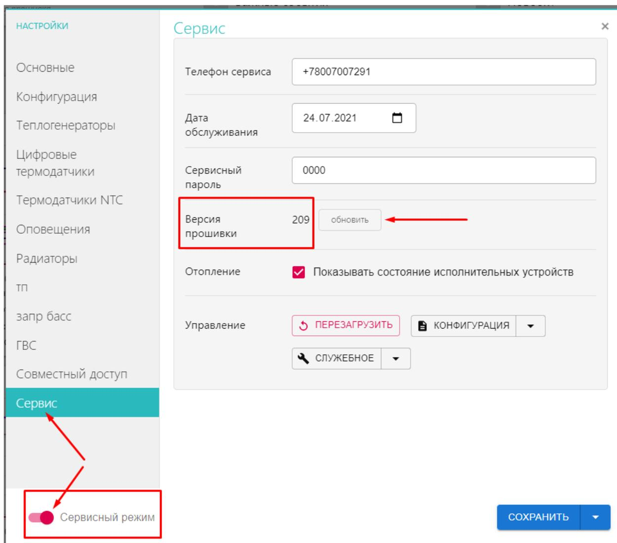
**ВНИМАНИЕ!!!** Во время обновления версии прошивки ни в коем случае нельзя отключать Регулятор от сети. В случае перебоев в питании и при не полностью заряженном внутреннем аккумуляторе может произойти сбой, что приведет к полной неработоспособности Регулятора. Восстановление работоспособности в этом случае возможно только в заводских условиях.
