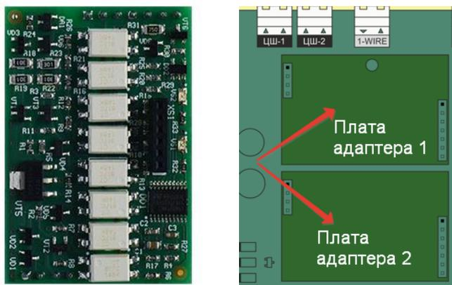
Данные платы реализуют возможность обмена данными и управления работой котла по поддерживаемому им цифровому интерфейсу:
