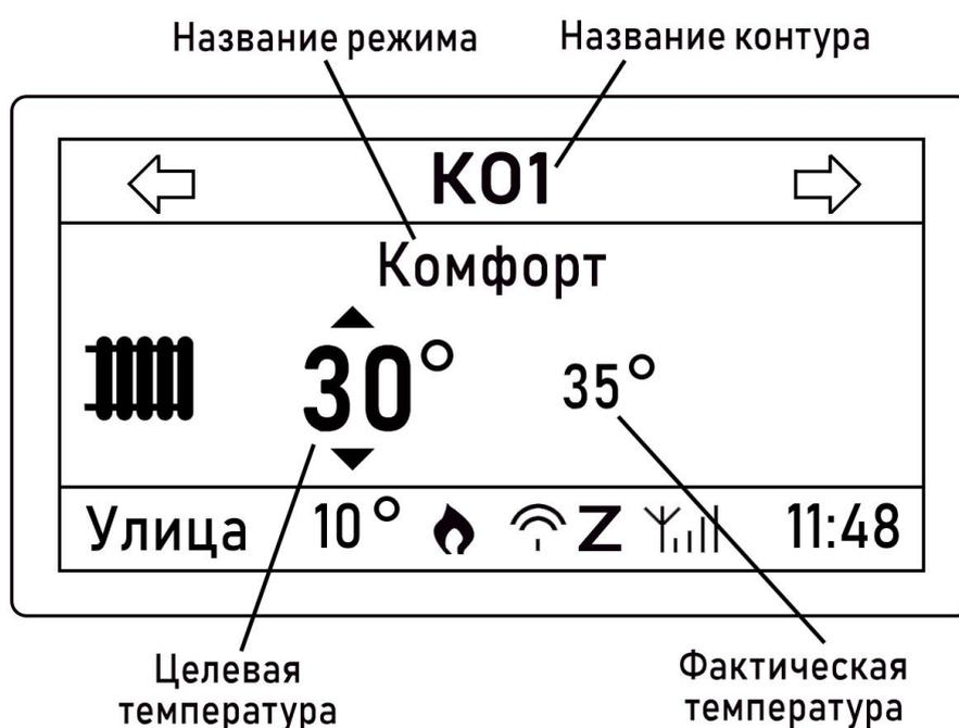
Контур управляется по теплоносителю или по воздуху при неисправном датчике
