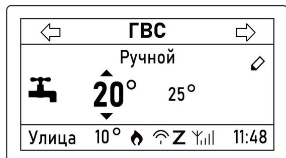
Регулятор в заводской конфигурации имеет 2 котловых контура, 3 контура отопления и 1 контур ГВС. Наименование контуров КО1, КО2, КО3 и ГВС заданы по умолчанию и могут быть заменены пользователем на индивидуальные. Ввод текста доступен с панели управления в сервисном режиме или из личного кабинета веб-сервиса (мобильного приложения) ZONT.
