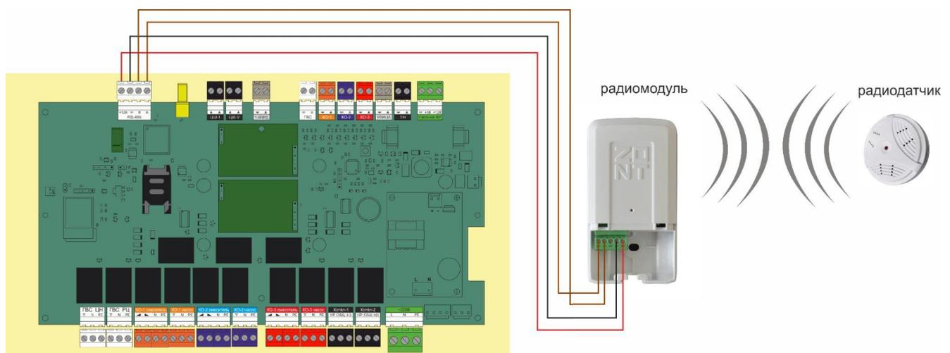
Для регистрации радиодатчика необходимо открыть меню “Термодатчики цифровые” и в поле “Регистрация радиоустройств” выбрать значение “Да”. На 120 секунд включается режим поиска и регистрации радиодатчиков.
