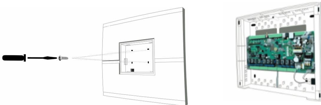
9. Установите панель управления Регулятора в основной корпус устройства.
