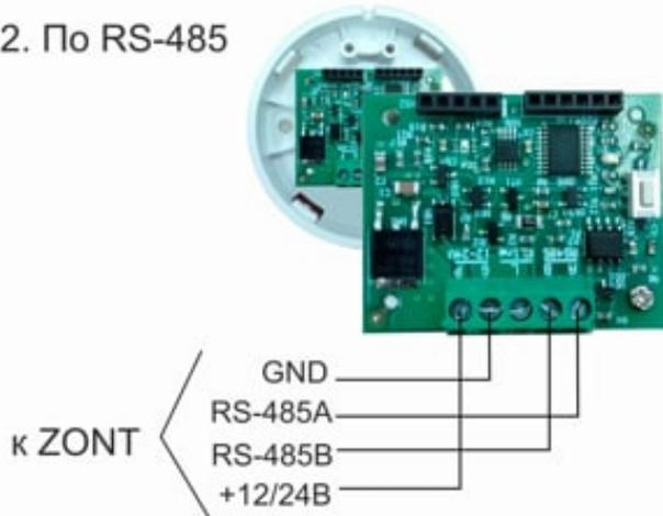
Максимальная длина линии RS-485 не более 200 м. При большем удалении датчика от Регулятора рекомендуется устанавливать дополнительные резисторы 120 Ом между клеммами А и В с обоих концов линии и использовать кабель UTP (витую пару) CAT5.
